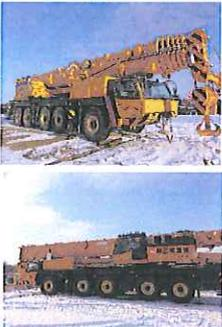
軽量で強度の高いラウンドブームの採用と、7段の「イージー・スカイピン機構」により、ブーム長さはクラス最長68m。最大地上揚程68m、最大作業半径64mの広大な作業空間を実現しました。さらにフルオートラフティングジブもラウンド断面を採用。格納時の全長を短く抑えることによりトラックによる搬送を可能にしました。ブーム・ジブ共に高張力鋼板を採用し、軽量かつ高剛性を実現しています。
